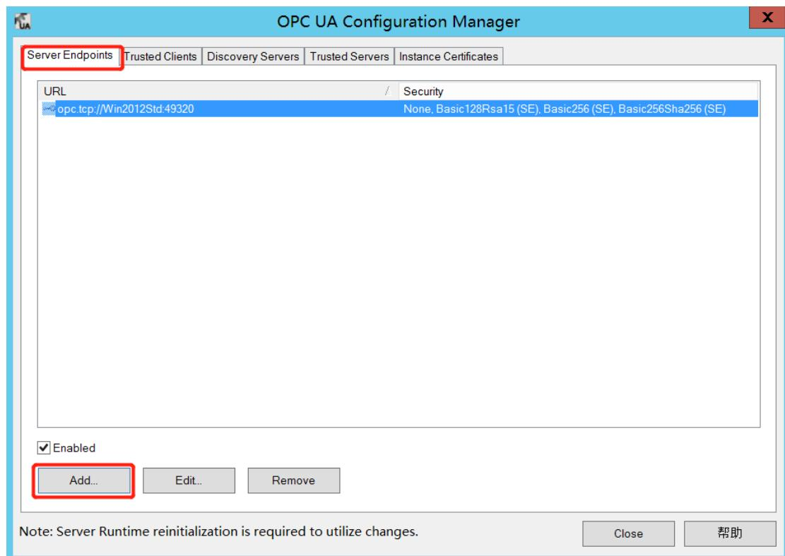
3. 定义 Endpoint, TCP 参数及 Security 参数根据实际情况选择。
