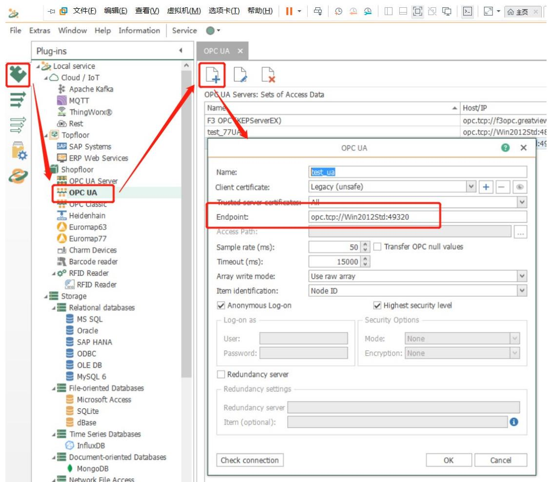
配置完成后，可以点击左下角：Check connection，验证连接成功。
