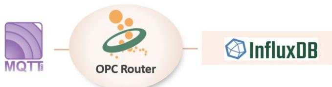
不断增长的物联网项目中越来越多的能够通过 MQTT 发送数据，通过 Router 的 MQTT 客户端插件，可以从 MQTT 代理接收消息，结合使用 influxDB 插件，可以将数据直接传输到 influxDB。
